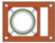
Bild 2: LAF-Premiumschorstein L+i, einzügig mit Installationsschacht
