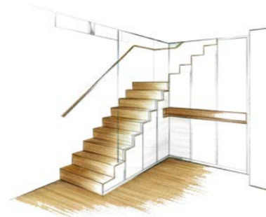
Faltwerkterre mit Einbaumöbeln unterbaut und in die Schrankfront integrierter Taschenleerer.
