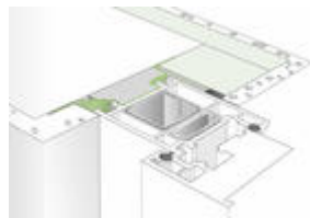
Bild 6: Befestigung der Folie innen wie Außenseite
