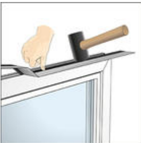
Bild 14: Geeignete Kederfolie in die äußeren Blendrahmen-Nuten einbringen
